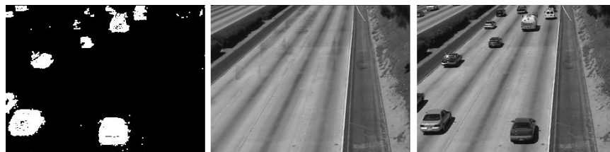
شکل ۱: یک فریم از یک ویدیوی نمونه، زمینه استخراج شده بر اساس روش مورد استفاده در مقاله و نتیجه شناسایی اشیاء متحرک مبتنی بر زمینه بدست آمده.
